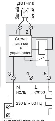
Схема 1. Упрощенная внутренняя схема и схема подключения
